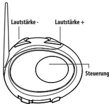
Das BT Cat 3 Multifunktionsgerät hat 3 Multifunktions Tasten und 3 Kabelanschlüsse auf der Unterseite.
