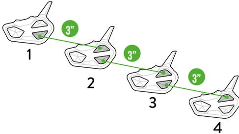
**Hinweis:** Die Konferenz ermöglicht die gleichzeitige Kommunikation zwischen Midland-Geräten. Die Geräte müssen in einer „Ketten“-Konfiguration gekoppelt werden.
