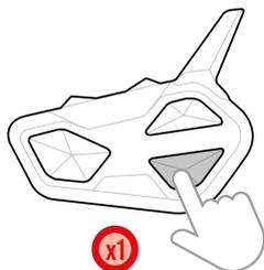
Einmal drücken, um die Konferenz zu dem auf **Taste Unten** gekoppelten Gerät zu **öffnen/schließen**.
