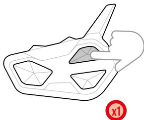
Einmal drücken, um die Konferenz zu dem auf **Taste Oben** gekoppelten Gerät zu **öffnen/schließen**.
