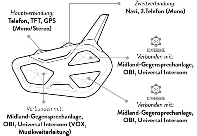
**ACHTUNG:** Zur Herstellung jeglicher Verbindungen, ist das Öffnen der Einstellungen erforderlich. Wenn Sie die Taste Control weniger als 7 Sekunden drücken, schaltet sich das Gerät ein, anstatt die Einstellungen zu öffnen. In diesem Fall den Vorgang wiederholen.
