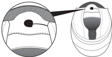
**Microfono a filo per i caschi integrali:** fissatelo al casco davanti alla bocca.
