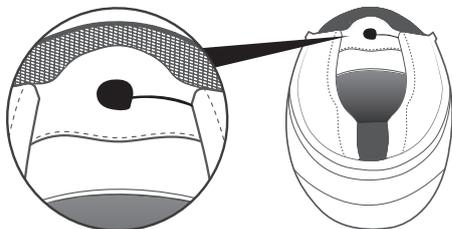
**Cascos integrales:** coloque el micrófono con cable justo en frente de su boca.
