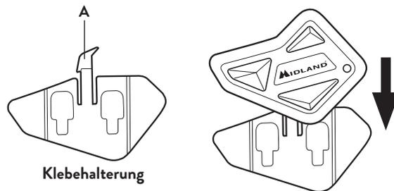
Das **BT Mini** wird einfach am Helm befestigt, indem es von oben auf die Schieberhalterung geschoben wird. Um das Gerät wieder abzunehmen, drücken Sie den Clip (A) und schieben Sie die Einheit nach oben.
