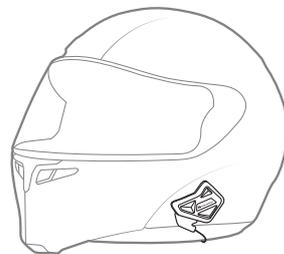
Fissate il dispositivo sul lato sinistro all'esterno del casco utilizzando il supporto biadesivo.
