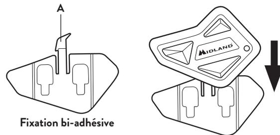
Le **BT Mini** peut être facilement monté sur le casque en le faisant glisser vers le bas afin qu'il s'insère dans la fente du support adhésif. Pour détacher le **BT Mini**, appuyez simplement sur le clip de fixation (A) et poussez l'appareil vers le haut.
