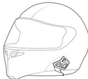
Befestigen Sie die externen Tasten mit dem 3M-Klebeband an der linken Seite Ihres Helms.
