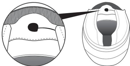
**Geschlossene Helme:** befestigen Sie den Mikrofonschaumstoff so dicht wie möglich am Mund.
