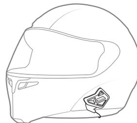
Coloque el **BT Mini** en el lado izquierdo del casco usando el soporte biadhesivo.
