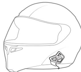
Τοποθετήστε το BT Mini στη αριστερή πλευρά του κράνους χρησιμοποιώντας την αυτοκόλλητη βάση.
