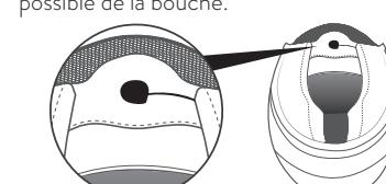
Le **BTX1 PRO S** peut être facilement monté sur le casque en le faisant glisser vers le bas afin qu'il s'insère dans la fente du support adhésif.
