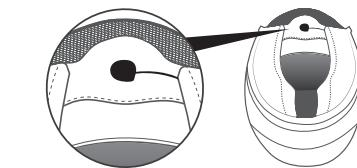
Das **BTX1 PRO S** wird einfach am Helm befestigt, indem es von oben auf die Schiebehalterung geschoben wird.
