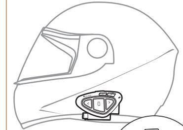
**Cascos integrales:** coloque el micrófono con cable justo en frente de su boca.
