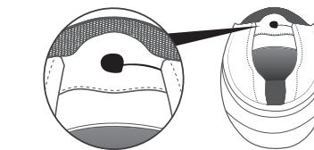
BTX1 PRO S puede ser fijado al casco fácilmente deslizándolo hacia abajo de manera que encaje en la ranura del soporte adhesivo.
