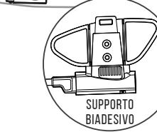
**Microfono a filo per i caschi integrali:** fissatelo al casco davanti alla bocca.
