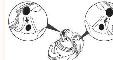
Para soltar **BTX1 PRO S**, simplemente presione el clip de fijación (A) y empuje la unidad hacia arriba.
