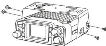
3. Ajuste un ángulo adecuado para la unidad usando las 3 ranuras en el borde trasero del soporte.
