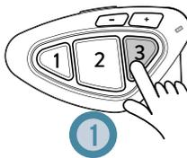
Einmal drücken, um die Konferenz zu dem auf **Taste 3** gekoppelten Gerät zu **öffnen/schliessen**.
