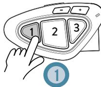
Einmal drücken, um die Konferenz zu dem auf **Taste 1** gekoppelten Gerät zu **öffnen/schliessen**.
